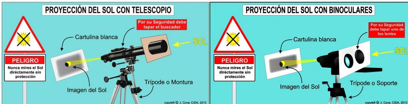
pantalla se debe colocar a una distancia de unos 25 a 30 cm del ocular del los binoculares, si se usa un telescopio este debe ser preferiblemente del tipo refractor y la pantalla de proyección se debe colocar a unos 40 cm del ocular, hay que tener especial cuidado en que los oculares usados para el método de proyección NO sean de lentillas plásticas y preferiblemente del tipo Kellner ya que los ortoscópicos, Plossl o Erfle corren el riesgo de dañarse por poseer elementos sensibles al calor.
